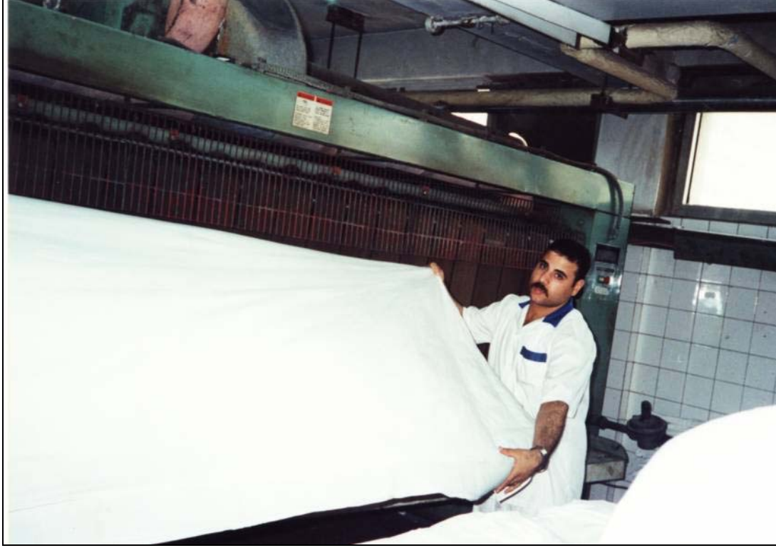
شكل رقم (٣ - ٦) : ماكينة الجندرة المستخدمة في كي ملءات الغرف بقسم المغسلة
